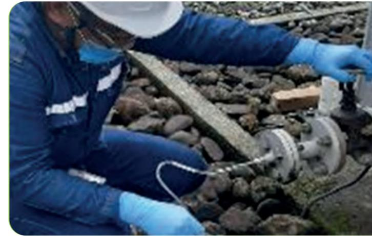
**Toma de muestra de aceite dieléctrico en transformadores de potencia, para análisis físico-químico y cromatografía de gases en laboratorio.**
