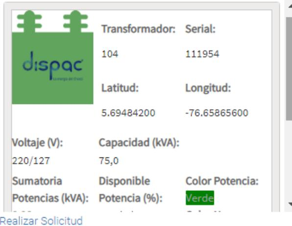
**Ilustración 4. Características del transformador**
